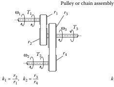
$r_1$ ,  $r_2$ ,  $r_3$  and  $r_4$  ---Radii of the pulleys
